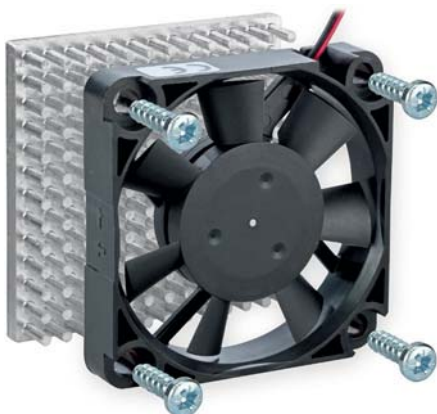
1 | Aktive Kühlung: Ein Axiallüfter steigert die Kühlleistung um ein Vielfaches
